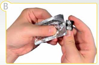
В. Нанесите на резьбу дифференциального соединителя (5) смазку ASL-3G (7), поставляемую вместе с базовым конусом (2).
