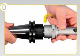
D. Накрутите передний конец базового конуса (2) на дифференциальный соединитель (5), расположенный в задней части расточной головки
