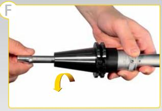
F. Вставьте удлинитель-квадрат (3) через базовый конус (2) в дифференциальный соединитель (5). Сохраняя соосность установочного штифта (6) и установочного паза, поворачивайте удлинитель (3) в направлении против часовой стрелки до соединения двух поверхностей Romicron. Убедитесь, что установочный штифт (6) вошел в паз базового конуса (2).
