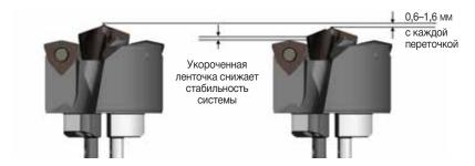
Только новые пластины KSEM PLUS гарантируют точность и эффективность работы модульных сверл KSEM PLUS. Если вы хотите использовать переточенные пластины, воспользуйтесь нашими специальными головками А1 и В1.
