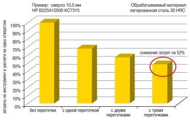
Услуги Kennametal по восстановлению режущих свойств инструмента обеспечивают значительную экономию на протяжении всего срока службы ваших режущих инструментов и могут сократить общую сумму расходов на технологическую оснастку более чем на 50%.
