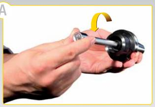
А. Извлеките дифференциальный соединитель (5) из базового конуса (2).
