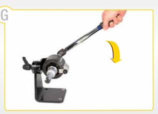
G. Затяните дифференциальный соединитель (5) с усилием, указанным в таблице ниже. Для этого используйте динамометрический ключ (4).
