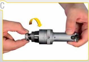
С. Вкрутите дифференциальный соединитель (5) в заднюю резьбу расточной головки (1) до упора. Дифференциальный соединитель (5) не нужно затягивать. Помните, что дифференциальный соединитель (5) имеет два разных винта, поэтому неправильная сборка исключена.
