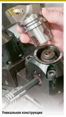
Уникальная конструкция крепления является отличительной особенностью быстросменной инструментальной оснастки КМ™, предназначенной для конического хвостовика с небольшим углом конуса.
