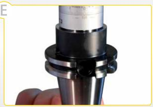
E. Слегка открутите базовый конус (2), чтобы установочный штифт (6) совпал с отметкой установочного паза на торцевой поверхности базового конуса (2).
