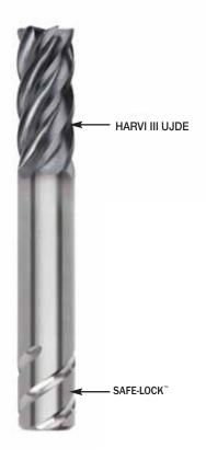
Фирменная конструкция HARVI III UJDE с неравномерным расположением зубьев и уникальной геометрией сердцевины для безвибрационной обработки и эксцентрическим затылком для высочайшей стойкости инструмента.
