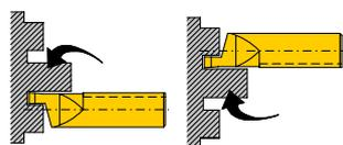
При вращения шпинделя по часовой стрелке используйте правую (R) пластину
