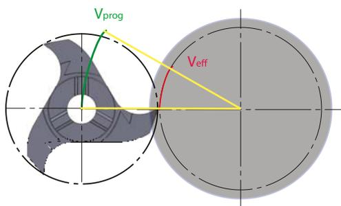
Фрезерование внутреннего контура
