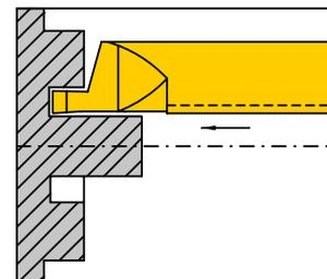
При вращения шпинделя против часовой стрелки используйте левую (L) пластину
