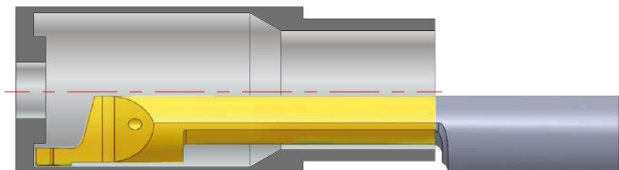
**ТОЧЕНИЕ ТОРЦЕВОЙ КАНАВКИ С РАДИУСОМ СКРУГЛЕНИЯ КРОМОК ОТ  $\varnothing 6.0$  ММ. ОБРАБОТКА ВОКРУГ ОСИ**
