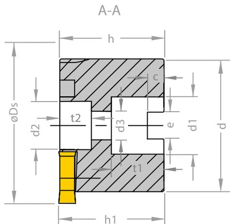
Посадочное отверстие с поперечным пазом по DIN 138
