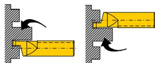
При вращения шпинделя по часовой стрелке используйте правую (R) пластину
