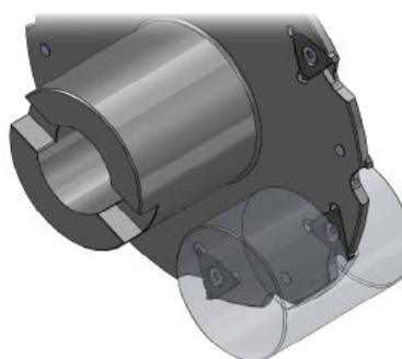
Посадочное отверстие с поперечным пазом по DIN 138
