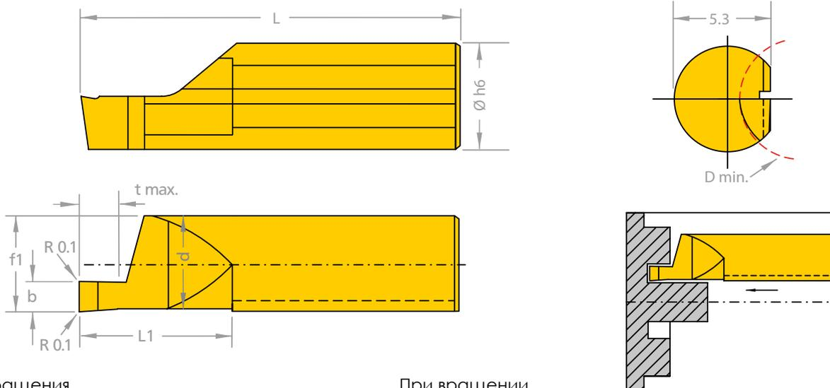
При вращения шпинделя против часовой стрелки используйте левую (L) пластину
